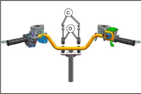
Открутите болты крепления руля (С), снимите блоки крепления руля;
