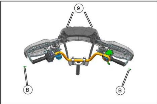
Зафиксируйте защиту рук на концах руля болтами (В), затяните болты;
