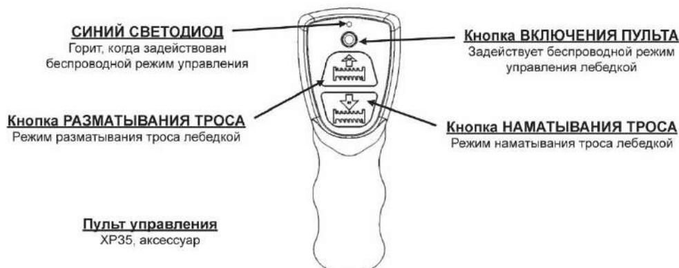
На представленном выше рисунке показан беспроводной пульт управления. Чтобы задействовать беспроводной пульт управления, нажмите и удерживайте кнопку включения пульта до момента, пока не загорится синий светодиод. Нажатие кнопки разматывания троса приведет к его выпуску. Нажатие кнопки наматывания троса приведет к его сматыванию. Беспроводной пульт управления автоматически отключится через 5–10 минут пассивного простоя.
