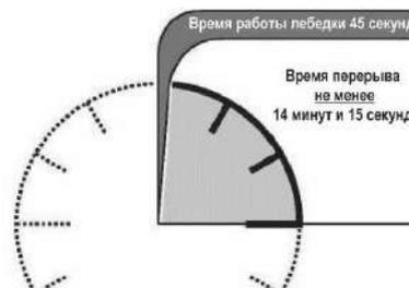
У лебедки нет автоматической защиты от перегрузки. Будьте осторожны при работе с аксессуарами (например, отвалом) или при сматывании троса в штатное положение.
