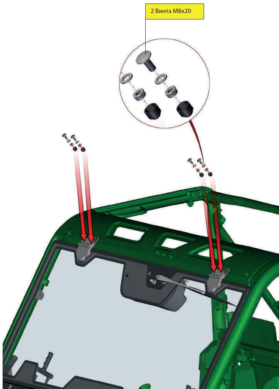
Установите передний амортизатор в держатели амортизатора и зафиксируйте его с помощью гаек, шайб и крышек, которые идут в комплекте. Повторите с другой стороны. Необходимо установить амортизатор в том же положении, что и на рисунке.
