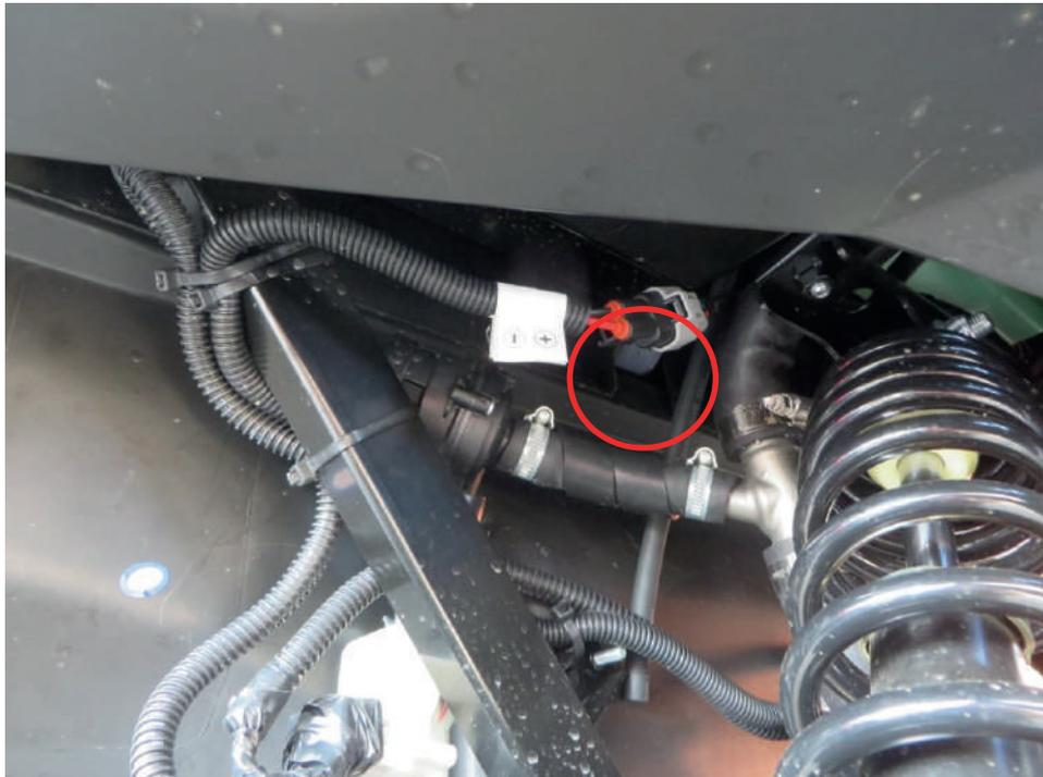
Соедините проводку стеклоочистителя и проводку омывателя с проводкой питания во внутреннем пространстве приборной панели
