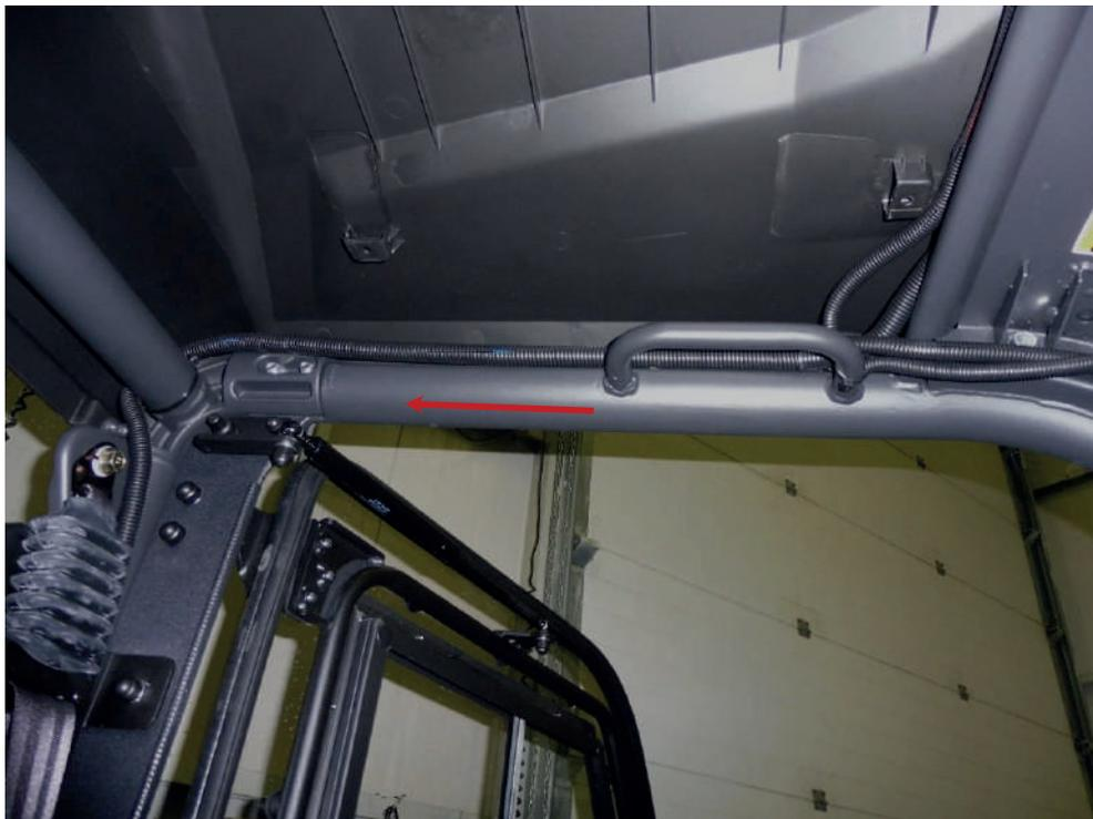
Установите бачок омывателя на раму машины с помощью прилагаемого держателя и винтов. Протяните шланг омывателя к бачку омывателя. Подсоедините шланг омывателя к бачку омывателя.
