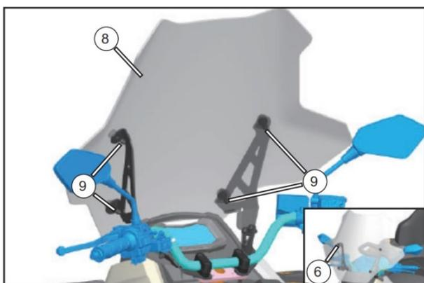
Совместите отверстия на ветровом стекле (8) с отверстиями кронштейнов стекла, установите винты М6х22 (6) и гайки (9). Затяните винты, будьте осторожны, не перетяните их, чтобы не повредить стекло;
