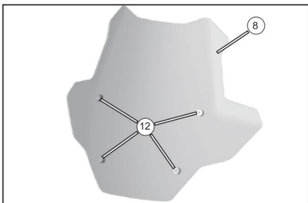
Установите вкладыши (12) во втулки, установленные ранее в ветровое стекло (8);
