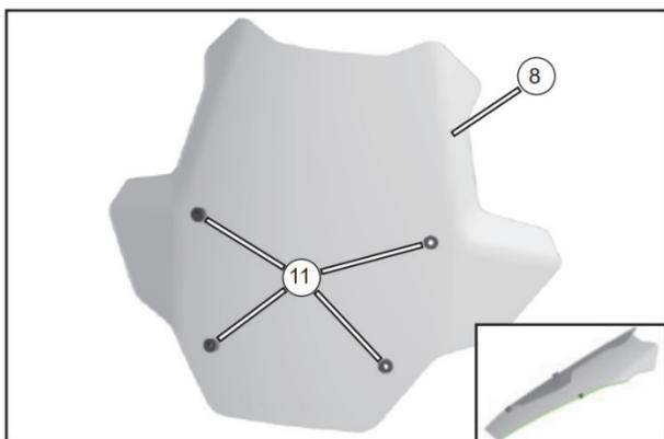
Установите втулки (11) в соответствующие отверстия на ветровом стекле (8);
