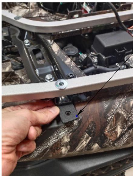
3. Закрепить слева и справа закладную пластину из комплекта бампера, как показано на рисунке.
