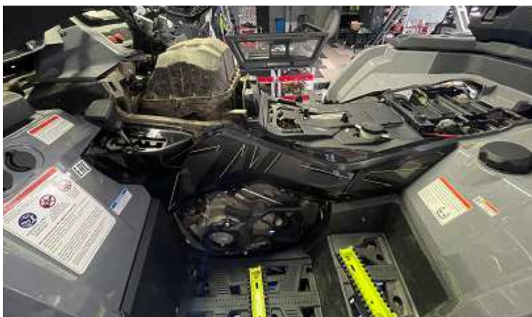
Снять сидения пассажира и водителя. Снять панель воздушного фильтра
