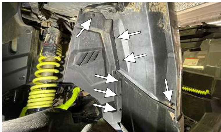
Снять пластиковые клипсы внутренней панели переднего крыла. Открутить болт крепления крыла и штатного порога
