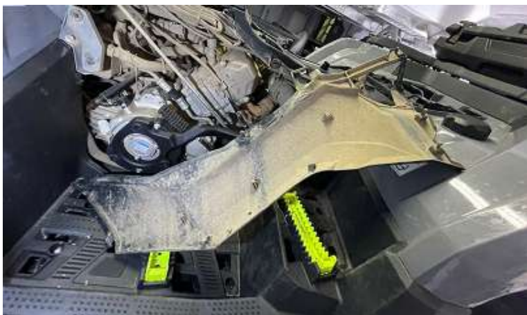
Снять боковую панель (переднюю часть «на себя»)
