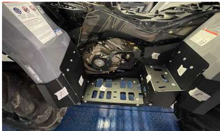
Установить узел из деталей (опора ног пассажира). Закрепить винтами. Затем установить панель №1. Наживить крепеж.
