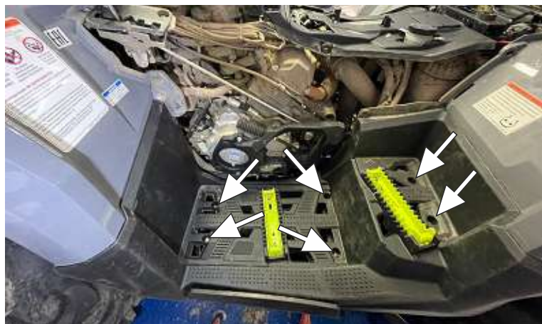
Открутить болты крепления штатной пластиковой подножки. Демонтировать панель защиты днища - защита порогов.
