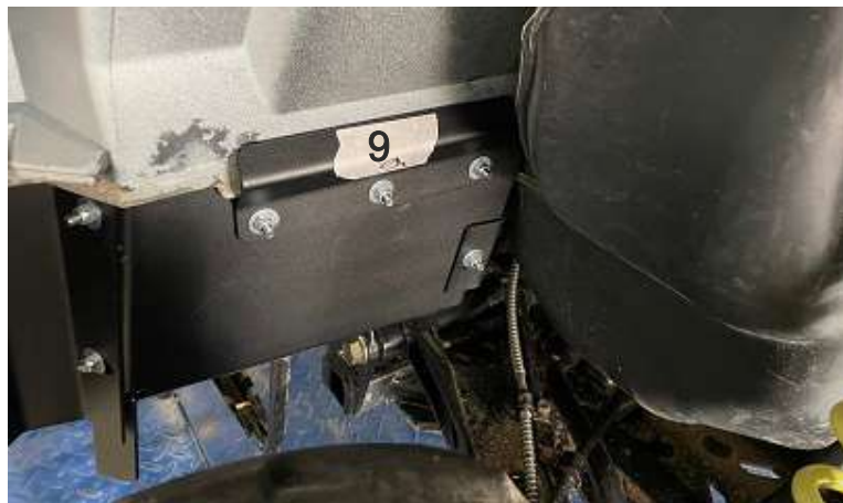
Закрепить штатное заднее крыло между панелями №6 и №9.
