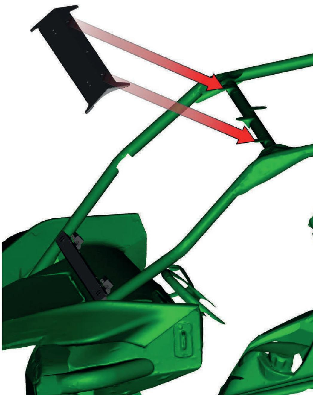
Закрепите верхнюю планку с рамой с помощью прилагаемых винтов, шайб, гаек и крышек.
