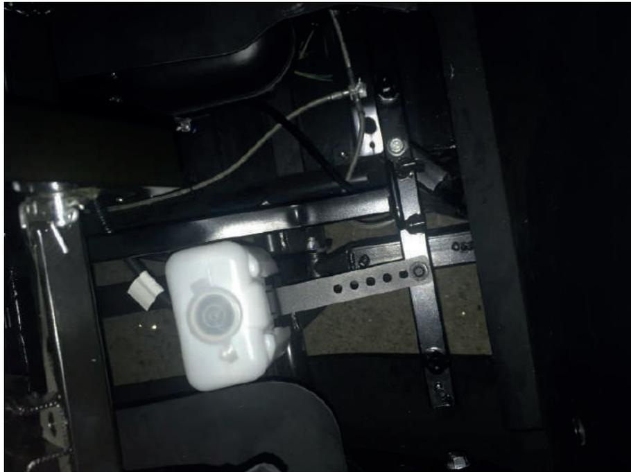
Протяните проводку омывателя от бака омывателя к центральному туннелю на полу.
