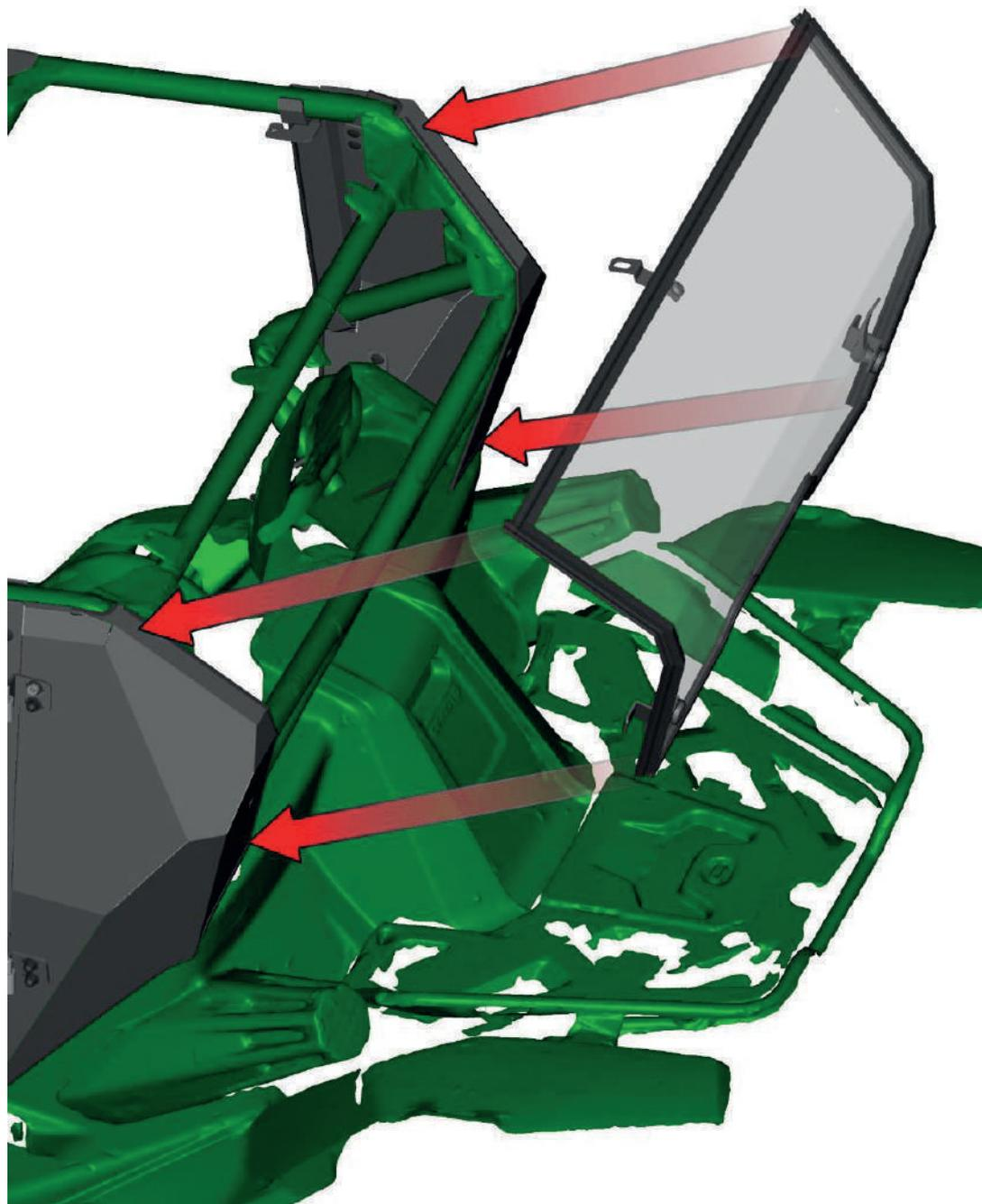
Закрепите заднее стекло с рамой с обеих сторон с помощью прилагаемого винта, шайб, трубки, гайки и крышки.
