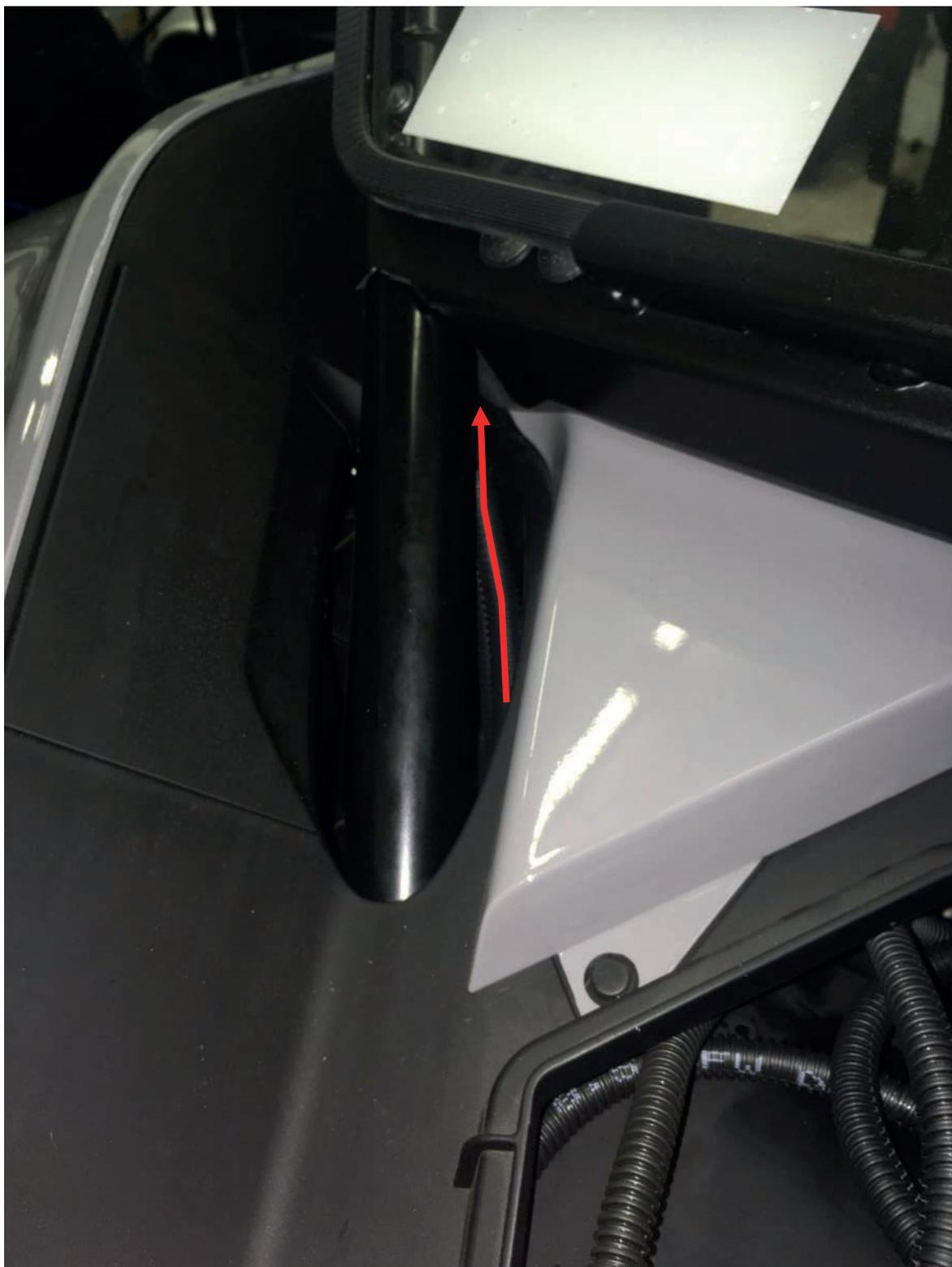
Протяните проводку стеклоочистителя и омывателя вокруг рамы к передней верхней части.
