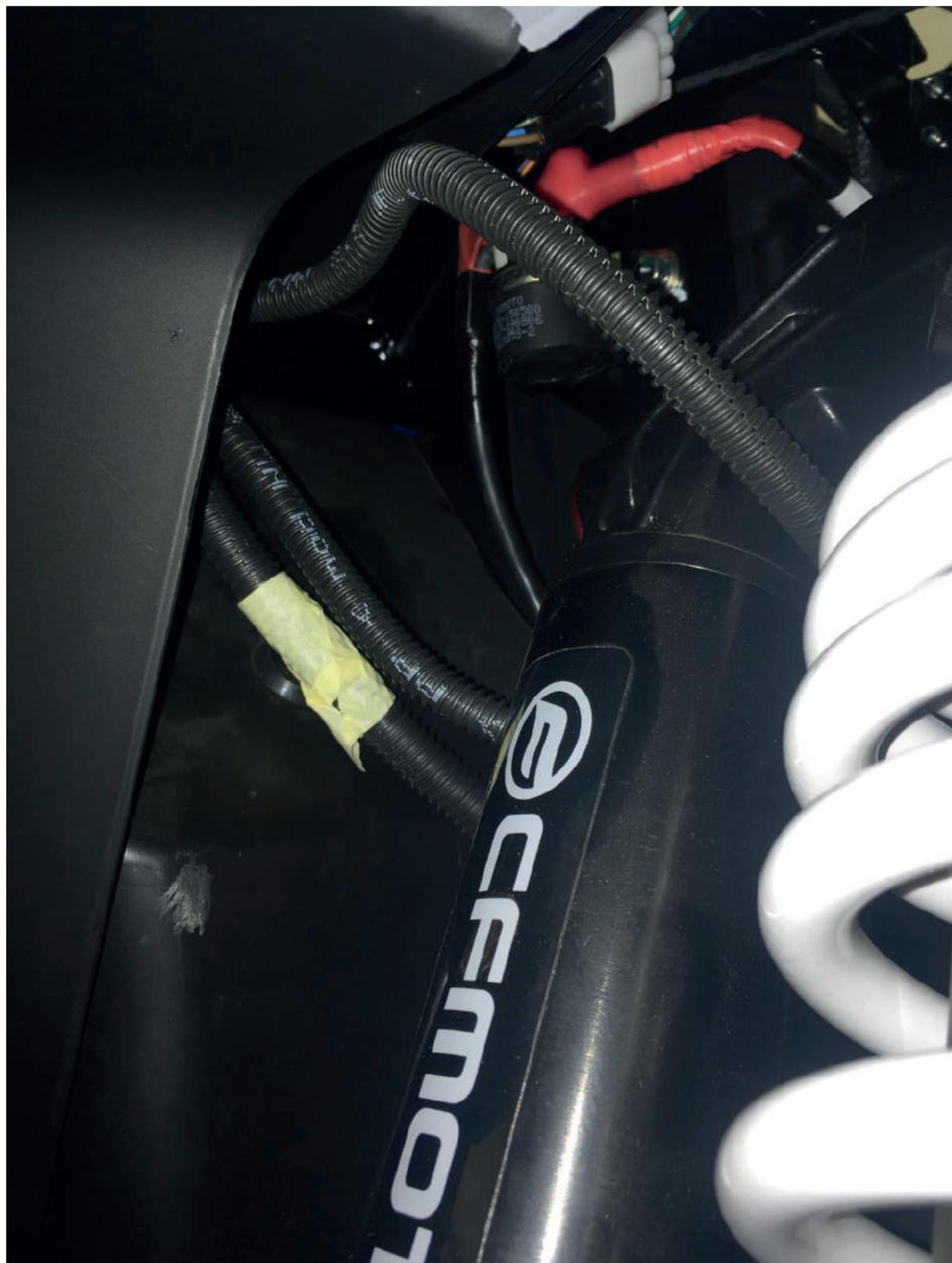
Протяните проводку омывателя "RELAY WASHER"
