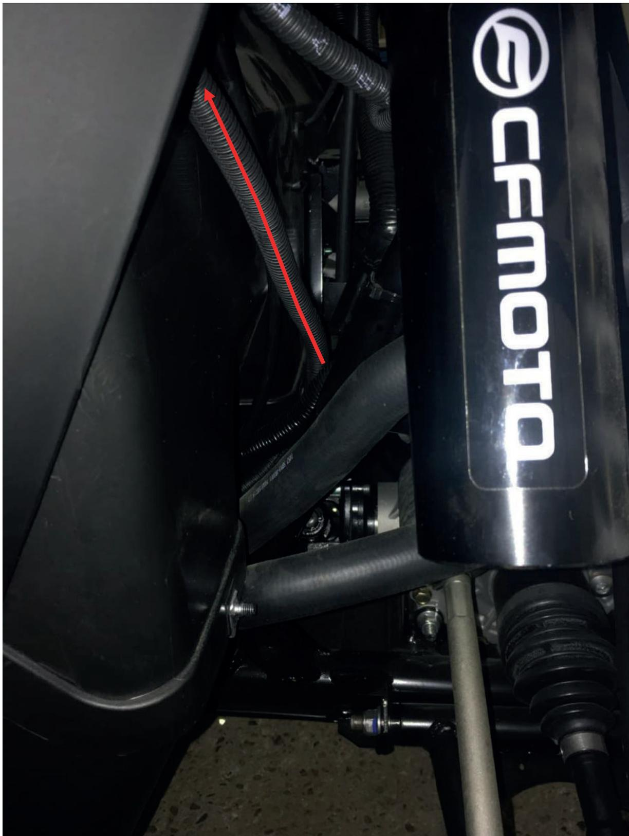
Протяните проводку омывателя через отверстие к передней приборной панели.
