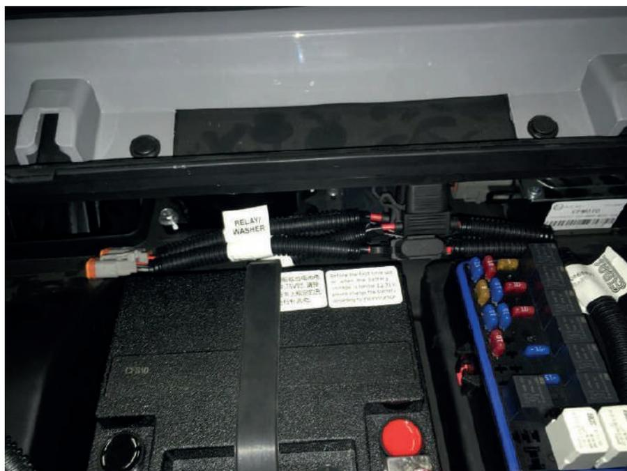
Найдите оригинальный провод с + 12 В АСС. Установите прилагаемый разъем крана на провод +12 В АСС. СМ. СЛЕДУЮЩИЕ СТРАНИЦЫ
