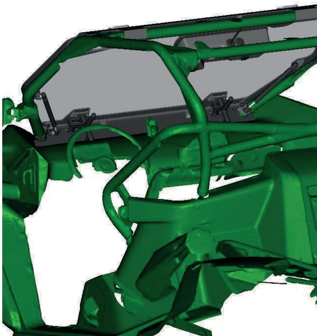
Поместите проводку стеклоочистителя в отсек для аккумулятора.
