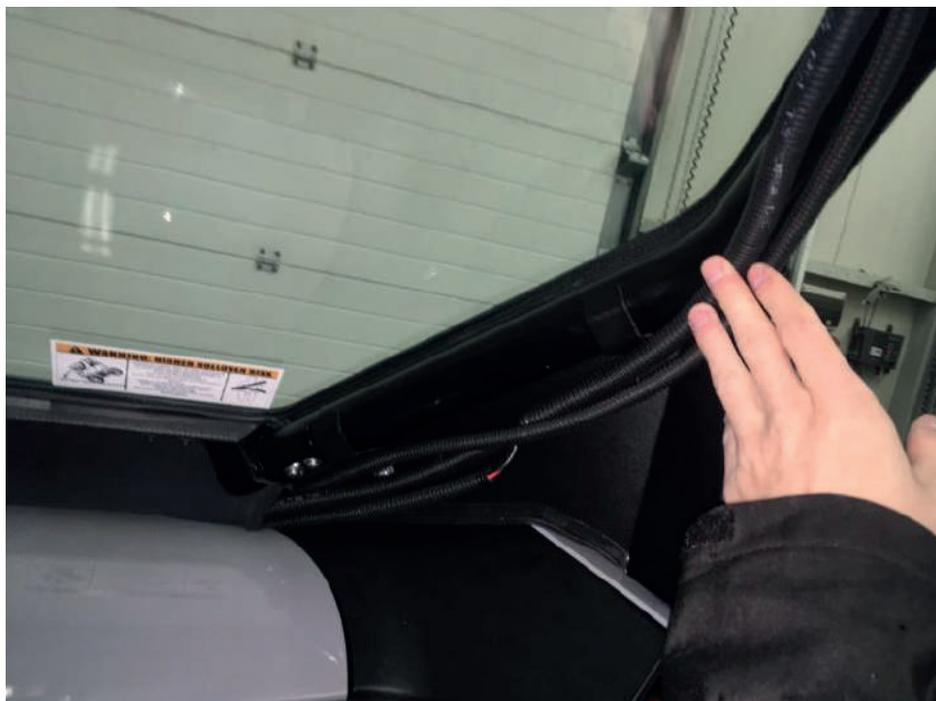
Соедините проводку омывателя, шланг омывателя и проводку стеклоочистителя с проводкой моторчика стеклоочистителя.
