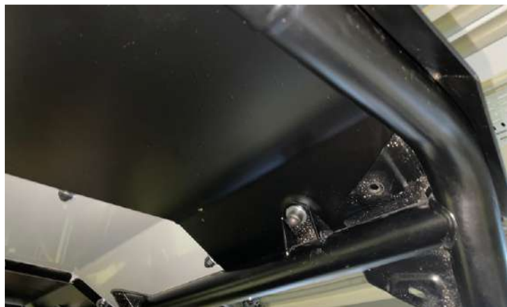
Наживите крепеж крыши к задней части каркаса
