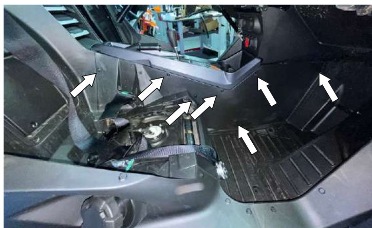
Снимите крепеж боковой панели пассажира
