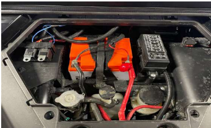
Подключить электрическую проводку к аккумулятору. Установить предохранитель.
