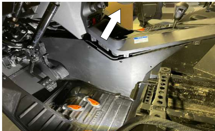
Приподнимите центральную панель
