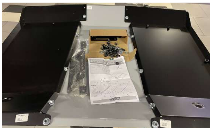
Наживите весь крепеж в отверстиях, согласно схеме.
