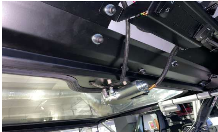
Убедиться в отсутствии натяжения в гофрах. Ослабить при необходимости.
