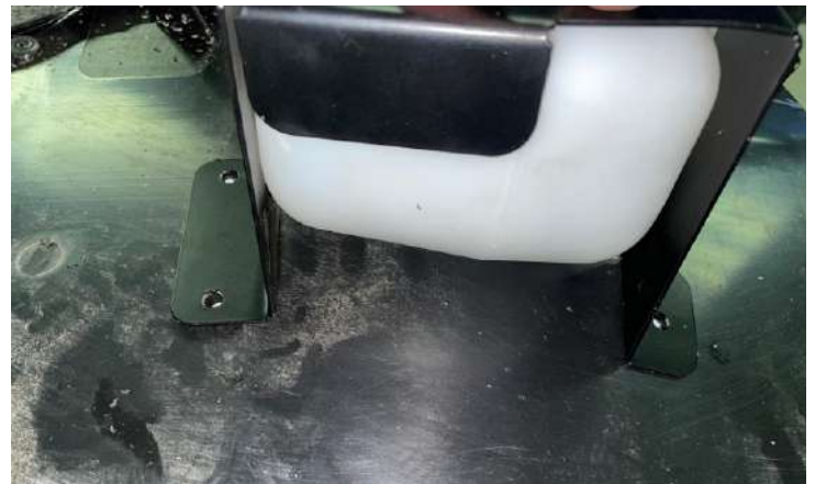
Разметить точки крепления кронштейна на пластике. Просверлить отверстия в пластике 7-8мм
