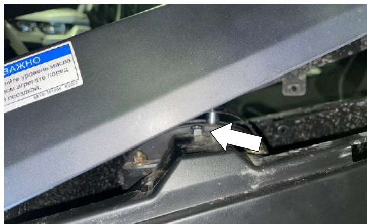
Открутить болт крепления панели водителя
