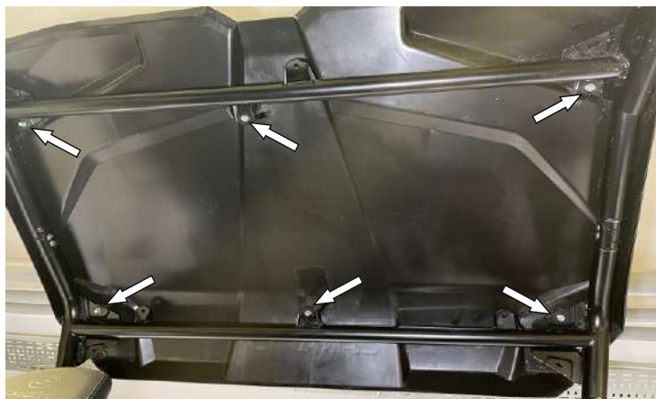
Снимите штатную пластиковую крышу
