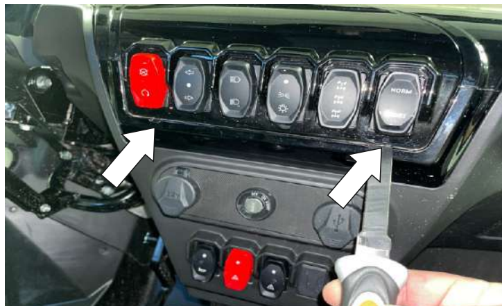
Съемником поддеть снизу центральную панель с кнопками
