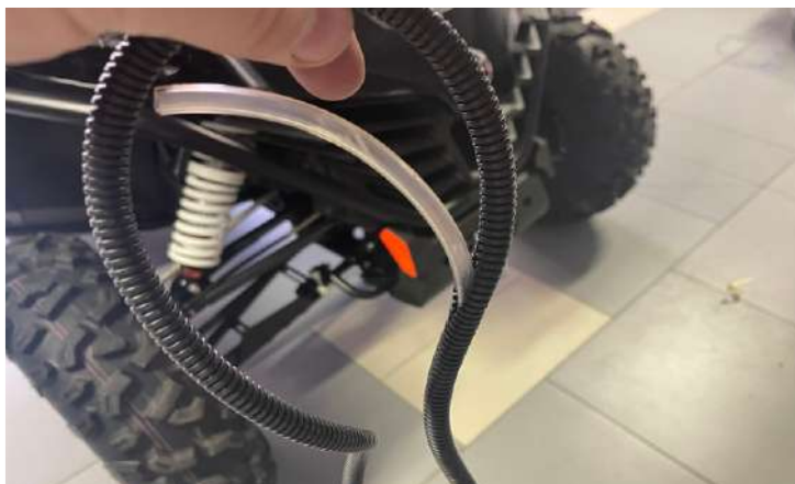
Продеть трубку стеклоомывателя в гофру
