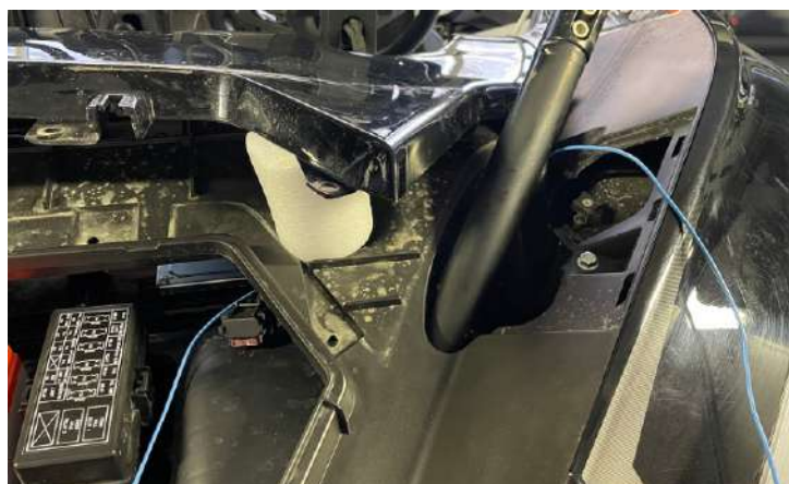
Протянуть провод-кондуктор (отрезок синего провода) для трубки стеклоомывателя. По аналогии с правой стороны.
