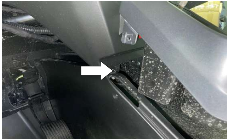
Открутить болт боковой левой панели.
