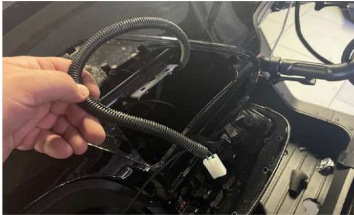
Конец электрической проводки протянуть через приборную панель - вниз к бачку омывателя.
