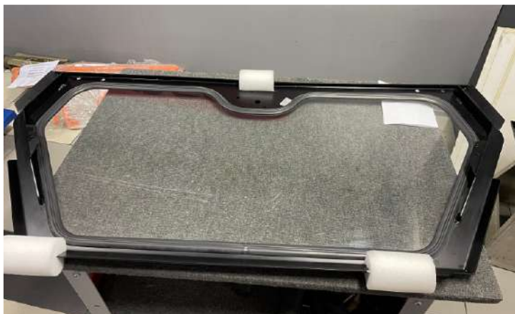
Разместить раму со стеклом на горизонтальной поверхности
