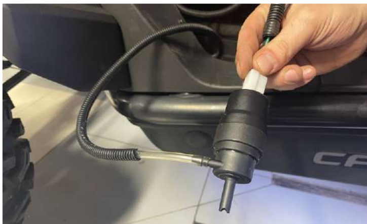
Установить трубку стеклоомывателя и разъем к насосу стеклоомывателя
