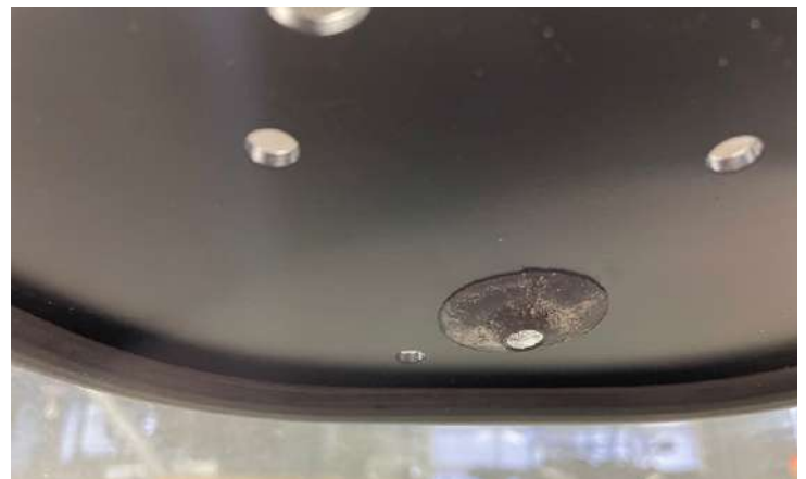
Установить уплотнение мотора стеклоочистителя
