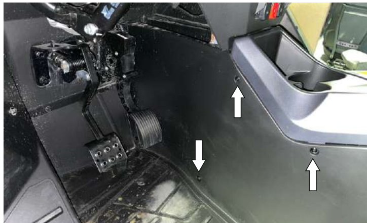
Снимите крепеж боковой панели ног водителя
