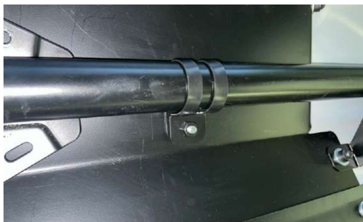
Наживите крепеж крыши и хомутов
