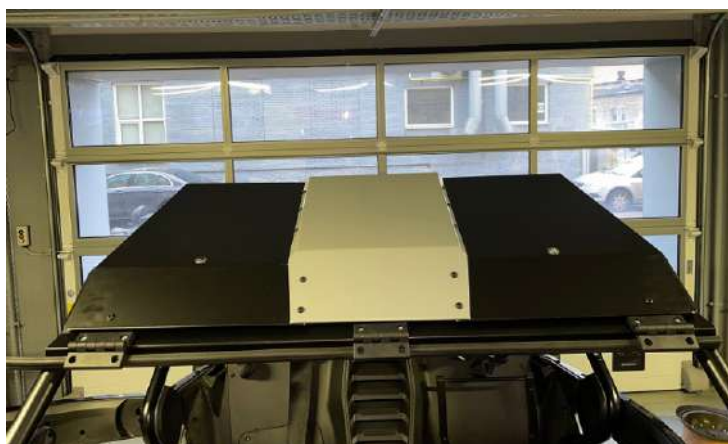
Установите алюминиевую крышу на каркас
