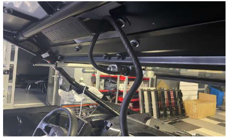
Подключить конец электрической проводки к мотору. Как на фото.
