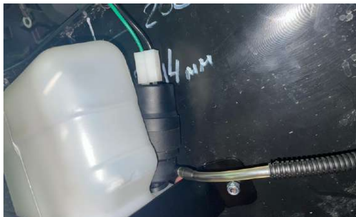
Установить моторчик стеклоомывателя на бачок. Установить пластиковую панель водительской стороны
