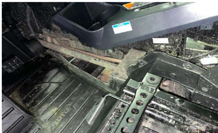
Снять панель водителя
