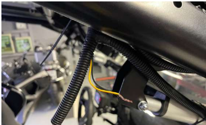
Соединить провода между собой. Изолировать соединение
