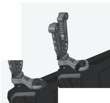
Поворотом рычага на кронштейне держателя надежно зафиксируйте держатель на багажной площадке;
