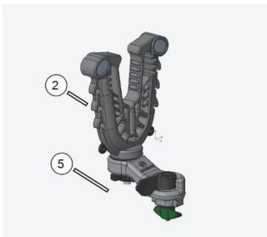
Ослабьте фиксатор (2) и установите держатель (5) в необходимое положение, затяните фиксатор (5);
