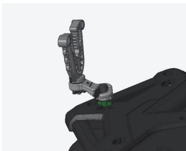
Установите кронштейн держателя в соответствующую ответную часть на багажной площадке (CF-Connect);
