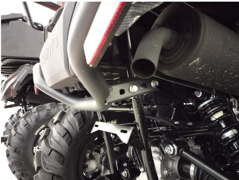
1. Открутить по 1 болту (слева и справа) крепления штатного подрамника. Второй болт не откручивать
