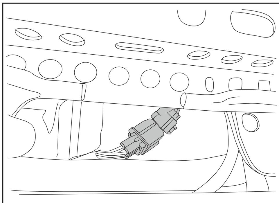
8. Прикрепить провод с помощью клипс, соединить коннекторы.
