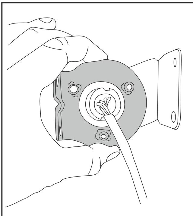
5. Установить снятый ранее кронштейн, закрутить штатными винтами.
