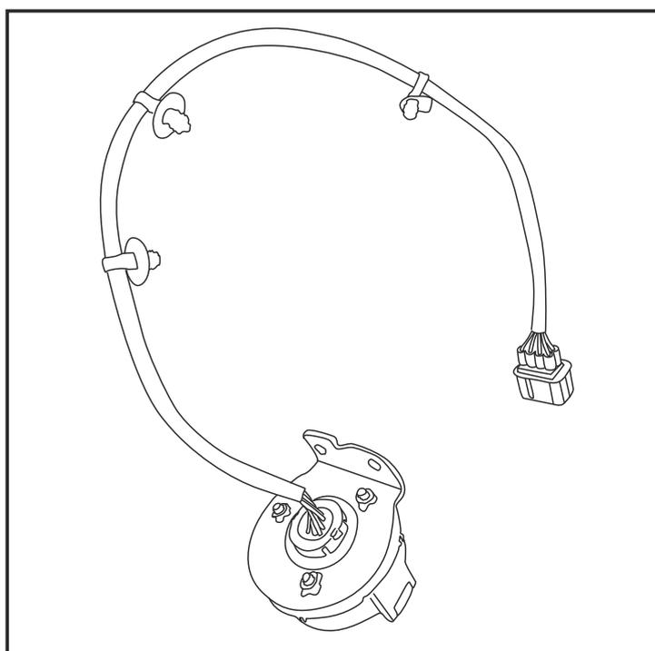
2. Снять розетку и провод.
