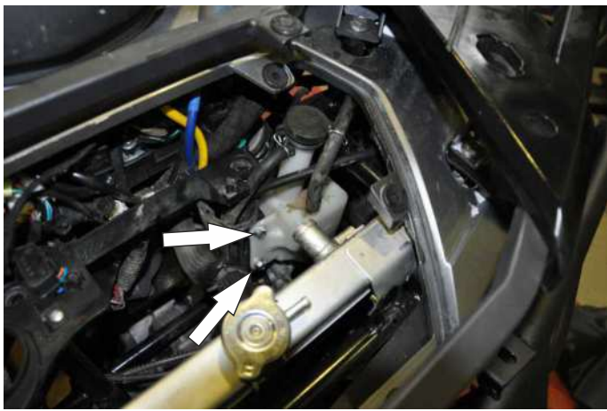
Открутите болты расширительного бачка
