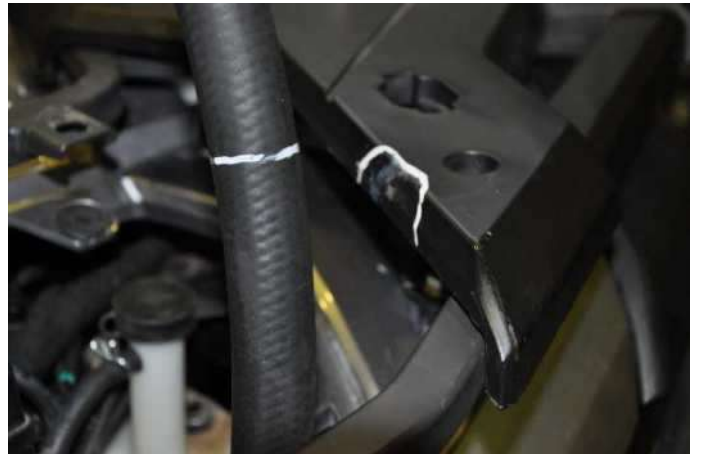
Соедините прямой патрубок из установочного комплекта с нижним патрубком, используя угловой соединитель
