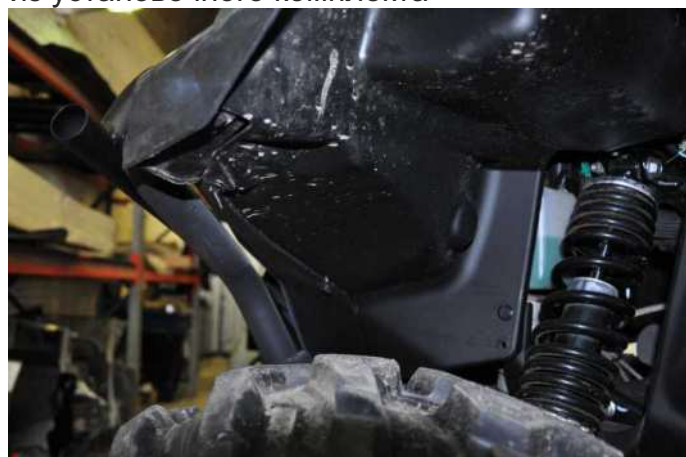
Установите внутреннюю пластиковую накладку с левой стороны
