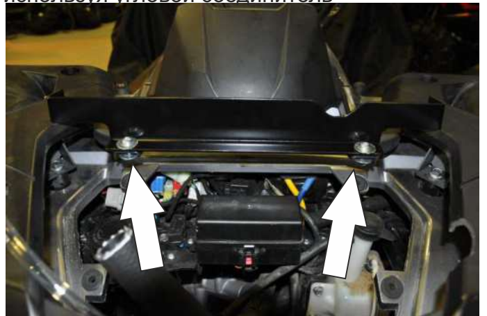
Установите кронштейн, используйте болты M8 из установочного комплекта
