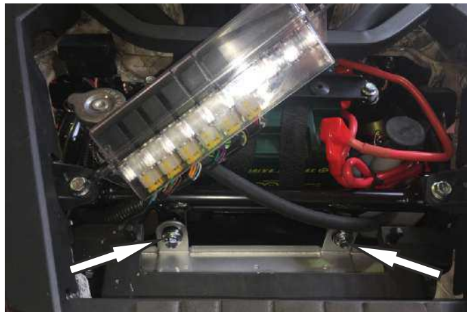
Открутите верхние болты крепления радиатора
