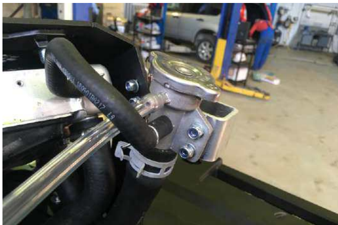
Подключите патрубок заливной горловины
