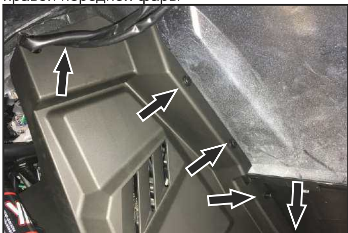
Снимите внутреннюю накладку с левой стороны
