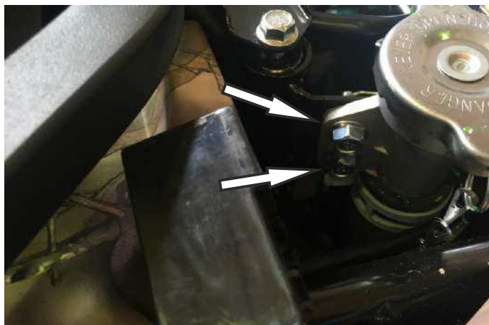
Открутите патрубков заливной горловины
