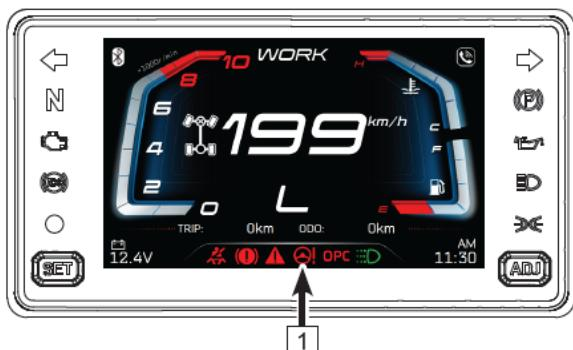
1 Индикатор неисправности электрического усилителя рулевого управления
